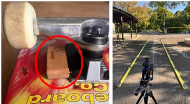
Abbildung 1: SF unter dem Skateboarddeck an der hinteren Achse montiert (links) sowie Versuchsaufbau mit dem LAVEG-System, OptoJump Next und Videokamera (rechts) (Scholz et al., 2026).
